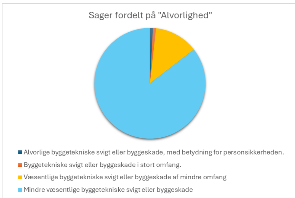
FIGUR 9. Sager registreret af den lovpligtige byggeskadeforsikring fordelt på "Alvorlighed". Udtræk er vedrørende "Bærende og stabiliserende konstruktioner" for perioden 14. september 2015 til 10. december 2024.
