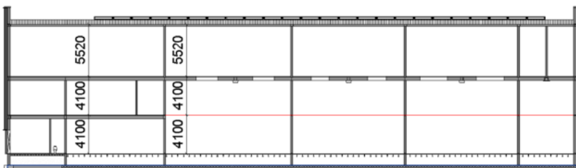
Figur 3. Eksempel på bygning hvor et indskudt dæk kan påvirke energirammen. I reference-designet er der et indskudt dæk (rød markering) mens dette er udeladt i det nuværende design.
